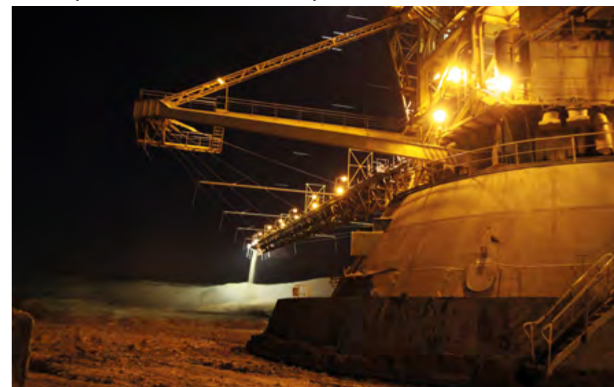
Zakládací výložník ZP 10000/Z 81 má délku neuvěřitelných 133 m.
